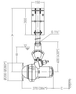
**A** = max. 2 m; **B** = min. 400 mm; **C** = min. 450 mm
